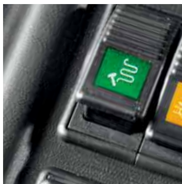
Pulsante per l'attivazione dello scuotifiltro
