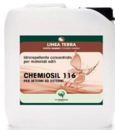
**Chemiosil 116** è un idrorepellente concentrato per materiali edili interni ed esterni. Microemulsione acquosa a base silanica ad alta concentrazione che alza la tensione superficiale e quindi limita la migrazione dei sali igroscopici in superficie unitamente ad antiestetiche macchie scure.
